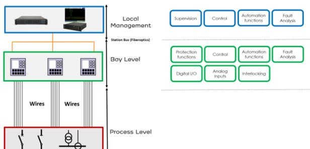
Figure 2. Standard Substation Automation System functionalities of EDP Distribuição.
