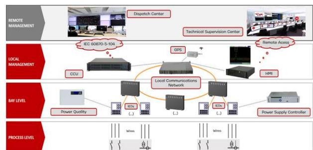
Figure 1. Standard Substation Automation System Architecture of EDP Distribuição.
