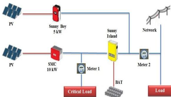
Fig. 3. Mehrsun micro-grid schematic diagram.
